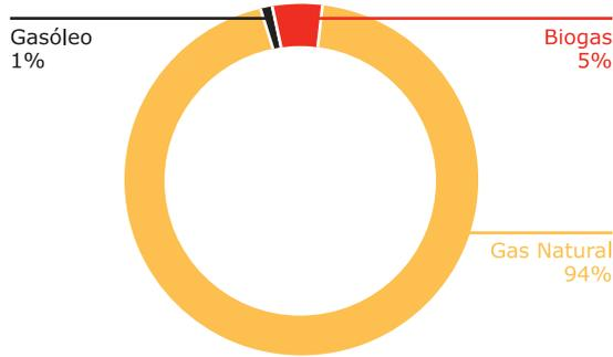
Se fomenta la recirculación de biogás generado en las Estaciones de Depuración de Agua Residual (EDAR) para su combustión en las calderas de generación de vapor, logrando un ahorro significativo en el consumo de gas natural.
